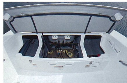
燃料タンクスペース・バッテリースペース
